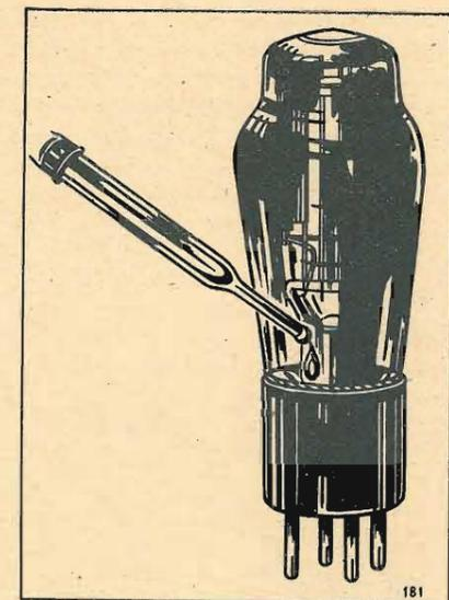
bulbo di vetro. Sovente detto zoccolo si stacca ed il bulbo di vetro si muove rispetto ad esso. Per ovviare tale inconveniente è sufficiente mettere alcune gocce di alcool denaturato fra lo zoccolo ed il vetro, come è indicato in figura, lasciare la valvola in posizione verticale per 24 ore e lo zoccolo aderirà nuovamente in modo perfetto al bulbo.
